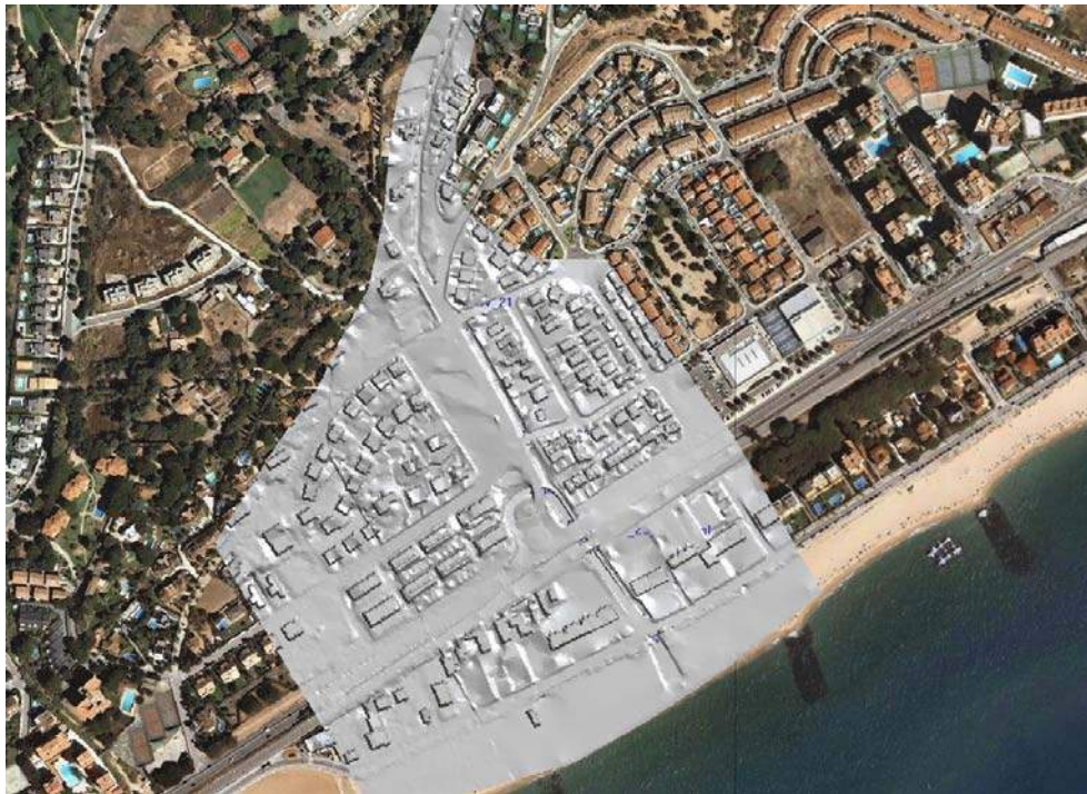
Figura 13. Exemple de la malla de càlcul 2D en la riera de Sant Vicenç. Model d'ombres de la malla de càlcul, en el tram final de la desembocadura.
