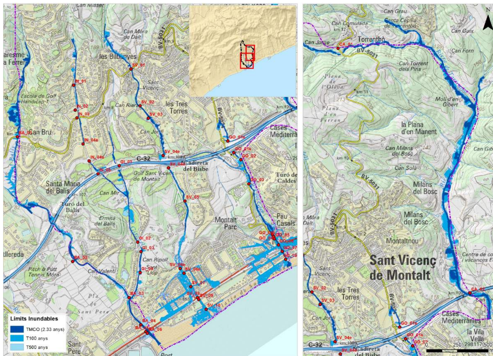
Figura 62. Esquema del mapa de zones inundables. Base topogràfica ICGC 1:25.000.
