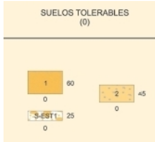
Figura 13. Detall de formació d'esplanada per un sòl tolerable i una categoria d'esplanada E1.
